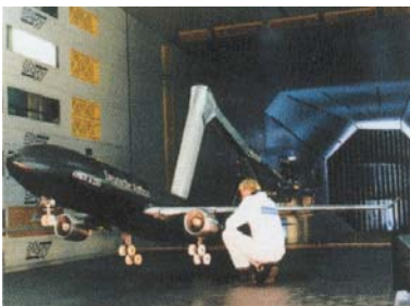
Figuur 2 - Een schaalmodel van een vliegtuig in een windtunnel.
