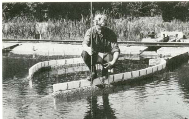
Figuur 1 - Een schaalmodel van een havenmonding.
