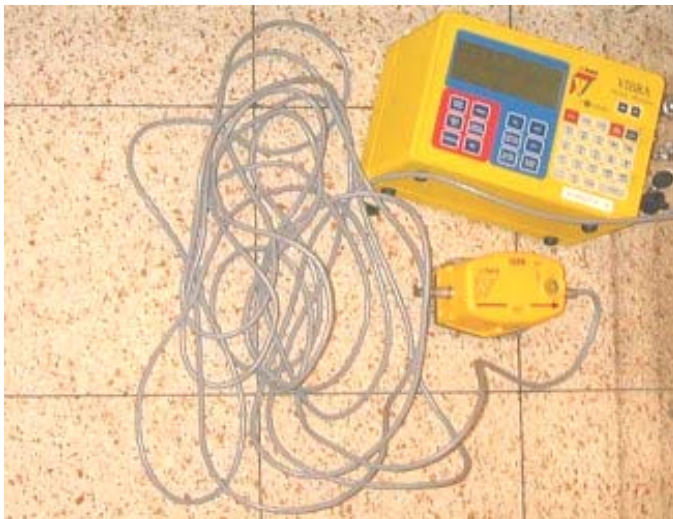
Figuur 1-2 Opnemer met meetkast Vibra
