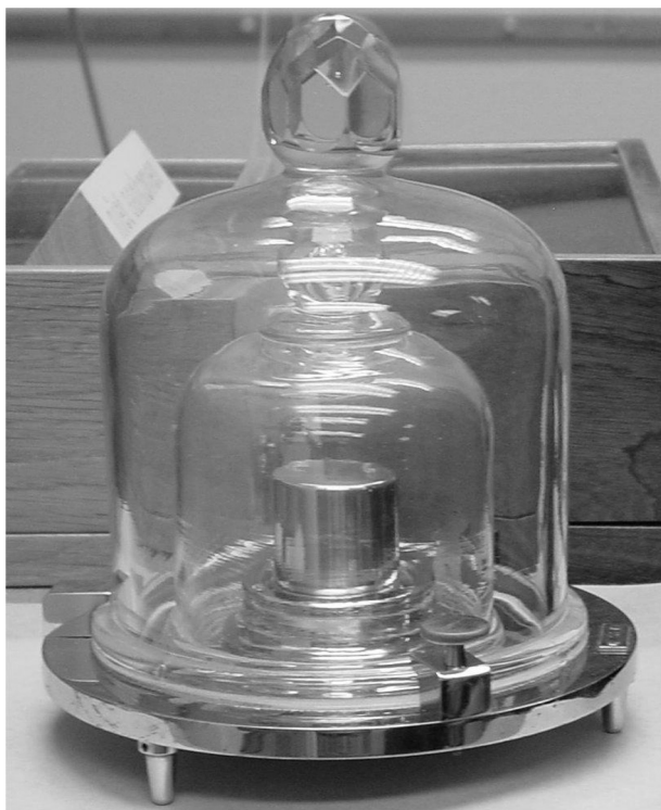
fig. 1 De Nederlandse standaardkilogram
