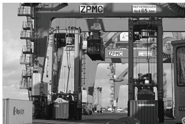
fig. 2 Kadekraan lost een container die vervolgens door de straddle carrier wordt opgetild (Amsterdam Container Terminals)
