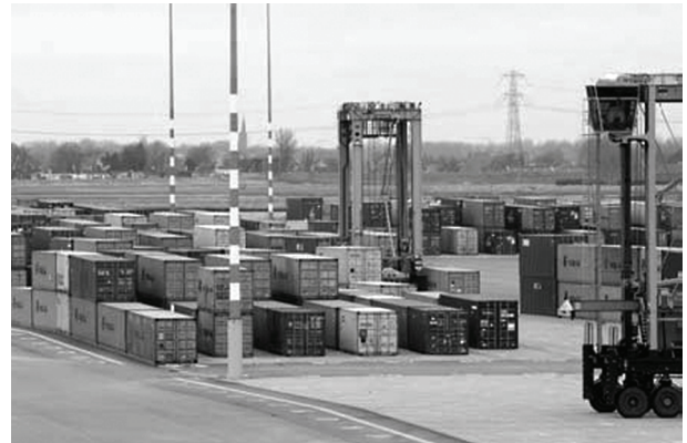
fig. 3 Straddle carrier slaat een container in de stack in (Amsterdam Container Terminals)
