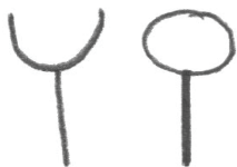
fig. 1 Symbool voor wandcontactdoos (enkelpolig; linkersymbool) en aansluitpunt (voor TV of telefoon; onbedraad; als het rondje zwart wordt gemaakt; is het een bedraad aansluitpunt)
